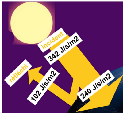
Figure 32: La Terre reçoit 342 \text{ J/(s} \cdot m^2) du Soleil, dont 102 \text{ J/(s} \cdot m^2) est directement renvoyé dans l'espace. Il reste donc 240 \text{ J/(s} \cdot m^2) qui sont absorbés par la Terre.
